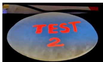
Suport de hârtie cu depunere „spray coating” Poli-HEA-Eu(III) expus la sursa UV
