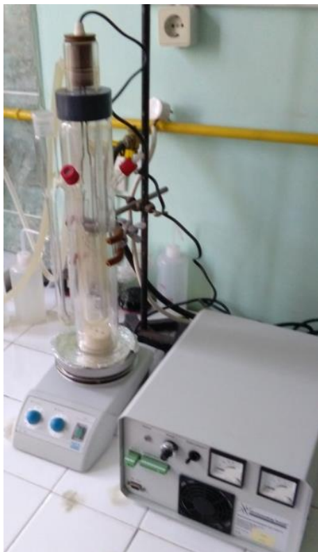
Fig. 25 Fotoreactor de laborator
