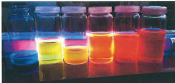
Nanocristale fluorescente de CdSe obținute prin metoda de sinteză coloidală elaborată în cadrul proiectului
