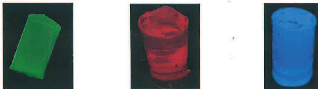
Figura 7. Compozite monolitice luminescente obținute prin introducerea complecșilor [\text{TbL}_3(\text{H}_2\text{O})_3] , [\text{EuL}_3(\text{H}_2\text{O})_3] , [\text{YL}_3(\text{H}_2\text{O})_3] în matrici de silice
